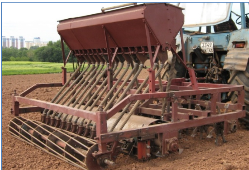
Рисунок 4. Опытный образец почвообрабатывающе-посевого агрегата АППН-2,1
