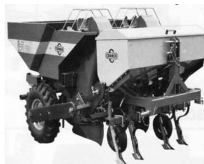
Rys. 4. Sadzarka taśmowo-czerpakowa Cramer Junior z siewnikiem do rzędownego wysiewu nawozów
