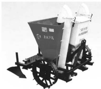
Rys. 1. Sadzarka łańcuchowo czerpakowa S 227 AKPIL z rzędownym dozownikiem nawozu
