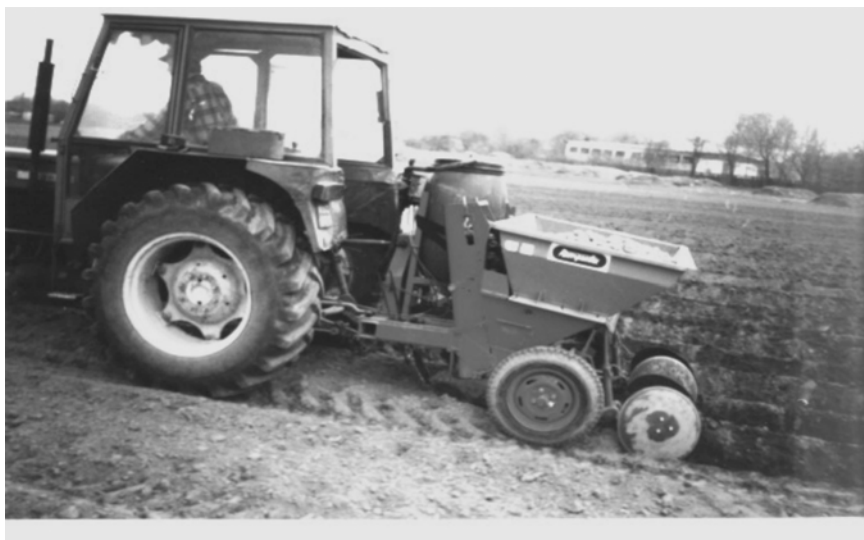
Rys. 5. Sadzarka taśmowo-czerpakowa S 211 z dozownikiem do rzędowego stosowania nawozów płynnych
