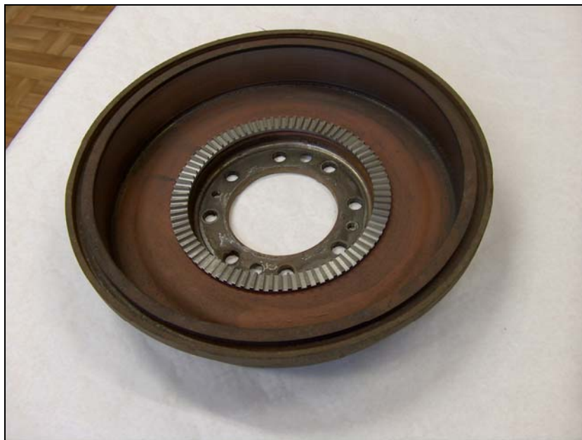
Rys. 2. Tarcza impulsowa tylnego koła Fig. 2. Back wheel impulse disk
