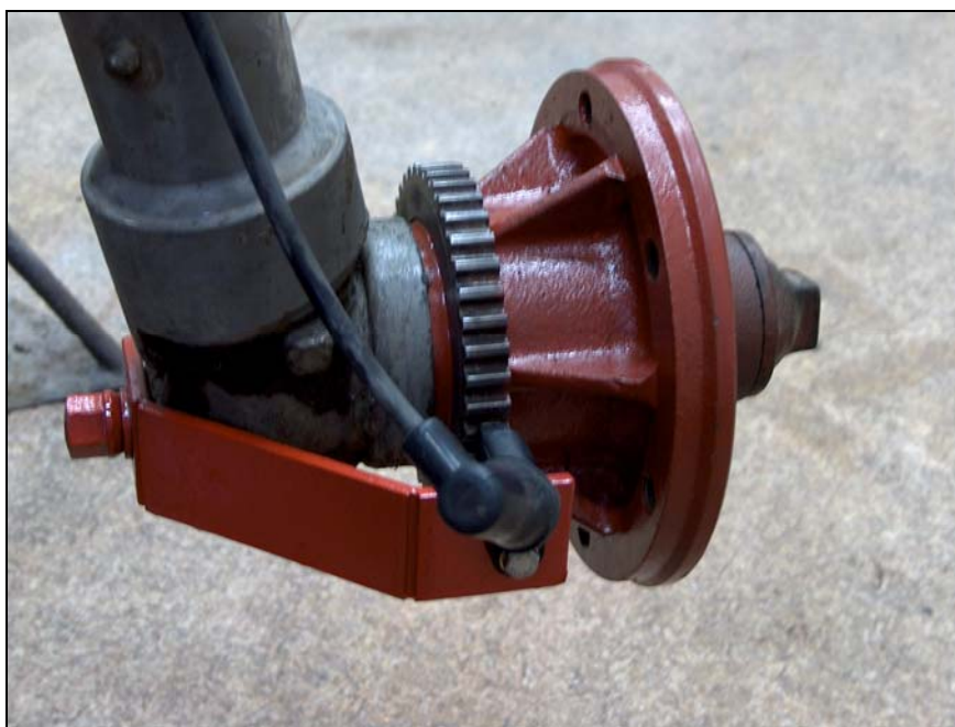
Rys. 1. Czujnik wraz z kołem impulsowym piasty przedniego koła
