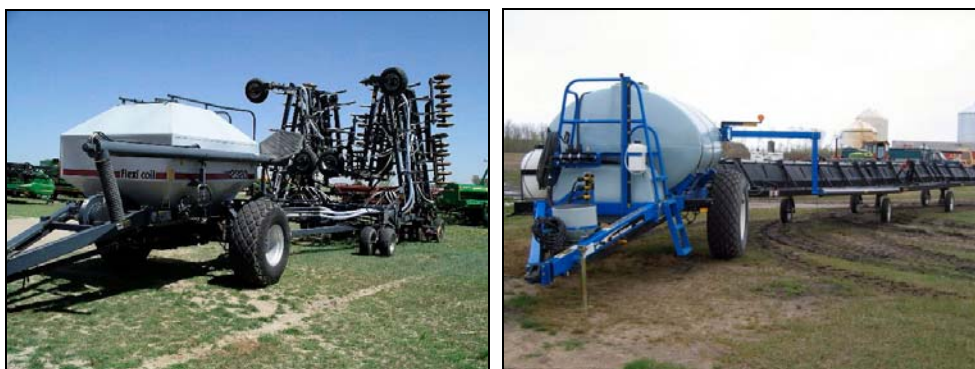
Rys. 1. Przykłady agregatów maszynowych stosowanych w uprawie zbóż: a) agregat uprawowo-siewny wymagający do pracy ciągnika o mocy min. 220 kW; b) opryskiwacz o szerokości roboczej 36 m w pozycji transportowej
