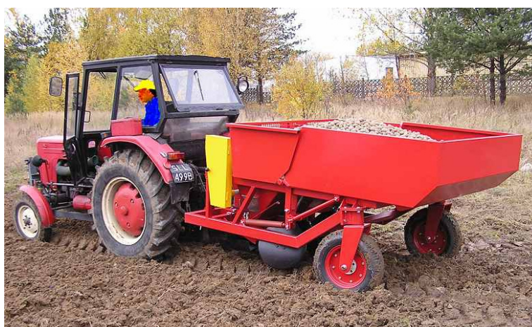
Rys. 1. Półzawieszana sadzarka do ziemniaków w trakcie prac polowych (w kabinie ciągnika widoczny jest kierowca)
