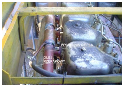
Rys. 5. Wymiennik ciepła typu woda-olej rzepakowy ciągnika Ursus C-360
