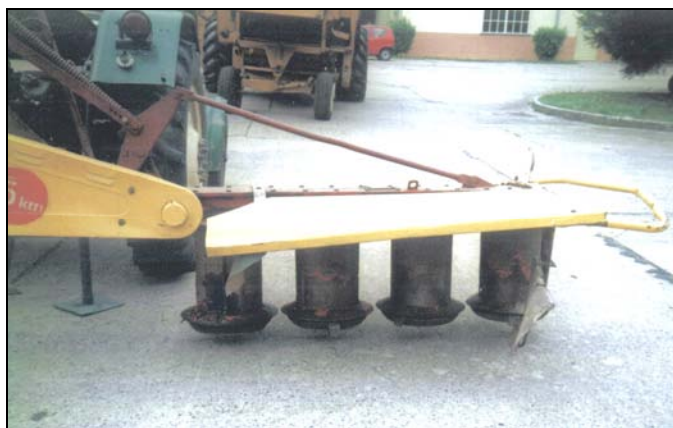
Rys. 1. Kosiarka rotacyjna czterobębnowa RzS-160 [Dudek i in. 2003]
