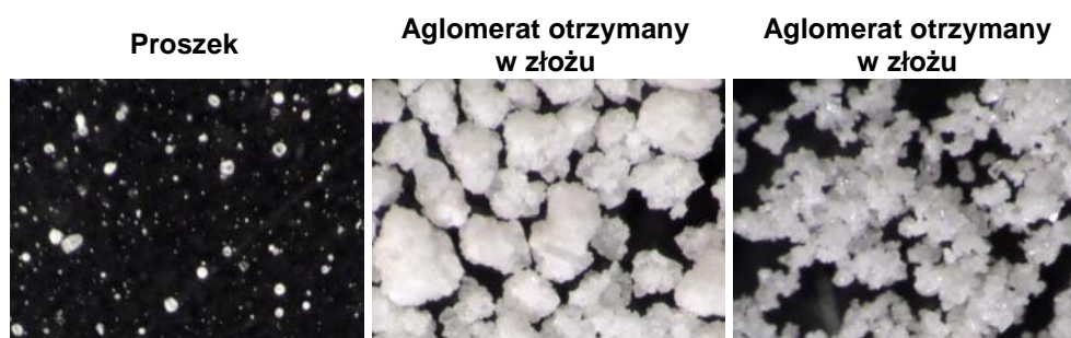
Rys. 1. Wpływ aglomeracji i jej rodzaju na kształt cząstek badanych mieszanin proszków spożywczych. Powiększenie 40 razy
