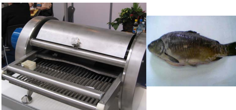
Rys. 6. Prototyp przecinarki ości w tuszkach ryb karpiovatych
