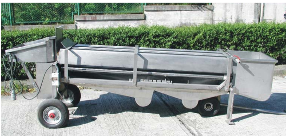
Rys. 3. Maszyna typu rolkowo-szczelinowego z bezpośrednim pomiarem grubości do sortowania wielkościowego żywych pstrągów i karp Fig. 3. Roller and aperture machine with direct thickness measurement for sorting alive trout and carp according to their size
