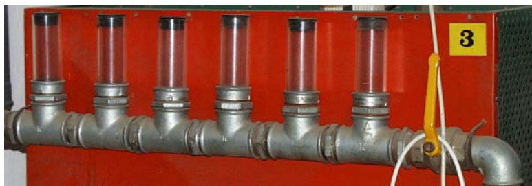
Rys. 1. Laboratoryjna suszarka przepływowa Fig. 1. Laboratory flow dryer
