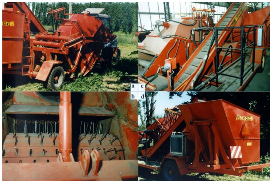
Rys. 1. Widok na główne zespoły kombajnu Magda 2: a – zespół zrywający strąki, b – bęben z palcami zrywającymi, c – przenośniki strąków, d – zbiornik na strąki
