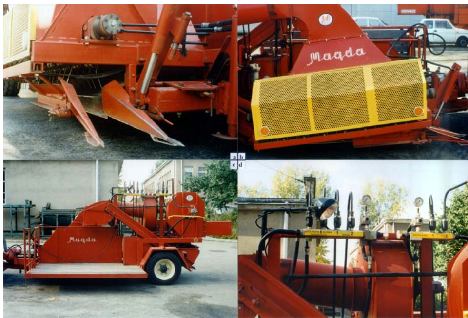
Rys. 1. Widok na wybrane zespoły robocze kombajnu Magda: a – podnośniki roślin zespołu zrywającego, b – kanał ssący pierwszego wentylatora, c – zespół czyszczący i pomost na skrzynki, d – hydrauliczny zespół sterujący
