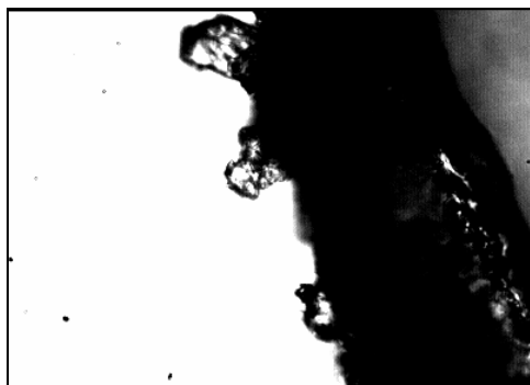
Rys. 5. Miejsce przerwania wypraski z 5% zawartością włókien celulozowych, temperatura procesu wtryskiwania 160°C Fig. 5. Place of breaking sample with 5% of cellulose fibres (production temperature 160°C)
