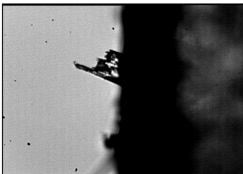
Rys. 4. Miejsce przerwania wypraski z 10% zawartością włókien lnianych, (temperatura procesu wtryskiwania 120°C) Fig. 4. Place of breaking sample with 10% of flax fibres (production temperature 120°C)
