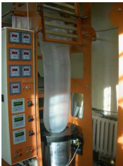
Fot. 2. Wytłaczanie folii TPS Photo 2. TPS film blowing
