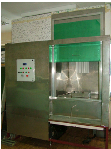
Rys. 3. Laboratoryjne urządzenie do chłodniczej obróbki w systemie impingement
