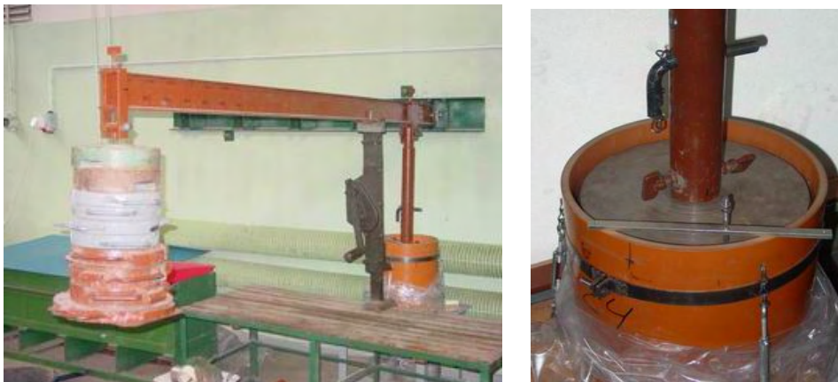
Rys. 7. Zagęszczanie warstwy materiału glebowego w cylindrze
