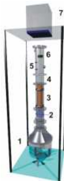
Rys. 2. Aparatura do wyznaczenia izobar sorpcji i desorpcji: 1-kocioł, 2-sekcja dodatkowa, 3-przegrzewacz, 4-warstwa uspokajająca, 5-czujnik temperatury, 6-szalka, 7-waga elektroniczna
