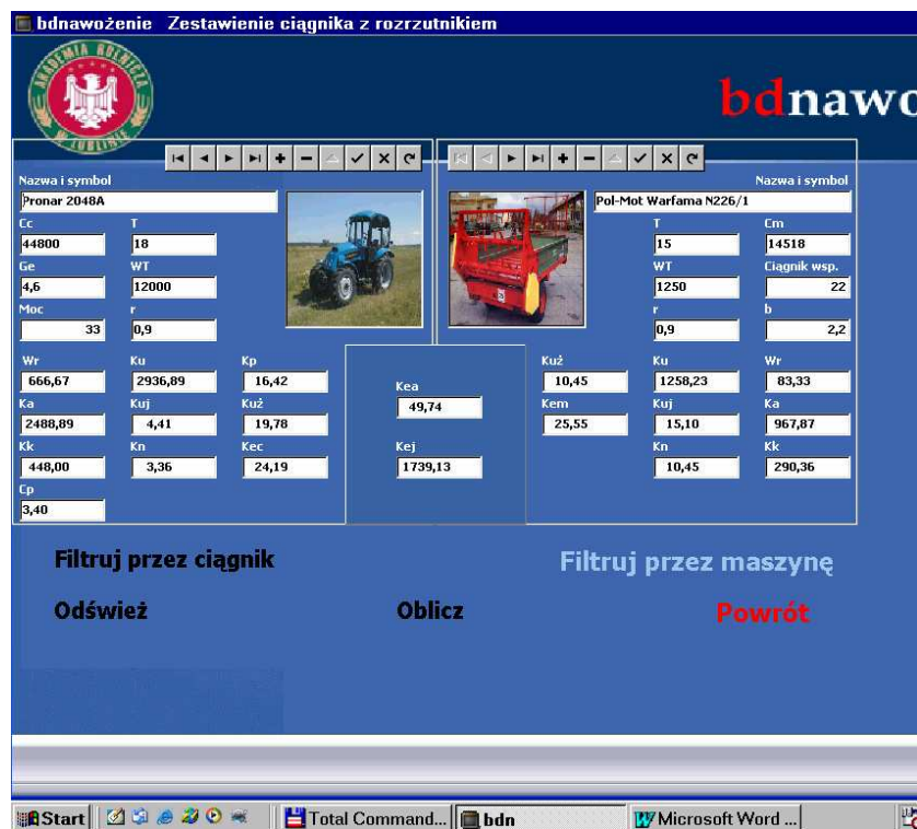
Rys. 4. Widok ekranu opisującego moduł zestawiania agregatu ciągnik + rozrzutnik obornika
