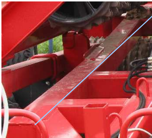
Rys. 7. Efekt zlekceważenia wyników obliczeń wytrzymałościowych (prototyp wału 15 m)
