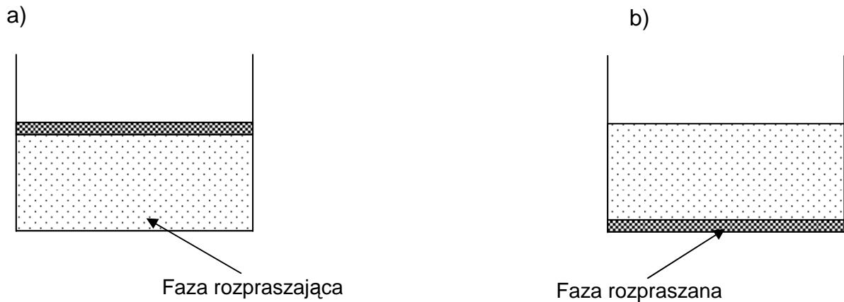
Rys. 1. Położenie fazy rozpraszanej przed rozpoczęciem mieszania: a) u góry, b) u dołu Fig. 1. Position of the phase being dispersed before start of mixing: a) upward, b) downward
