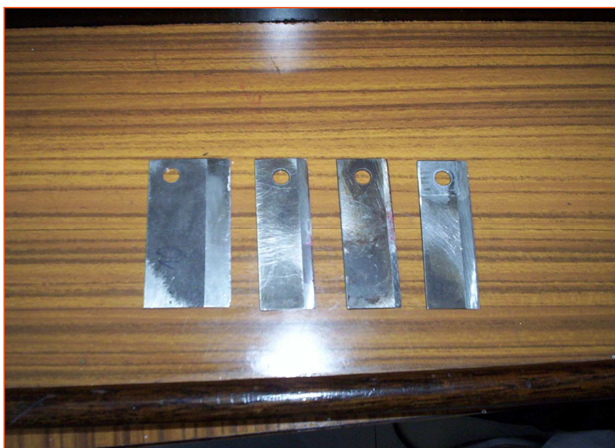
Rys. 3. Noże użyte do badań oporów cięcia. Fig.3. Cutting tools used t study cutting resistance
