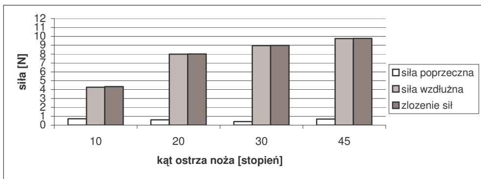
Rys. 4. Wpływ zależności oporów cięcia od kąta ostrza dla kąta przystawienia 0 stopni.
