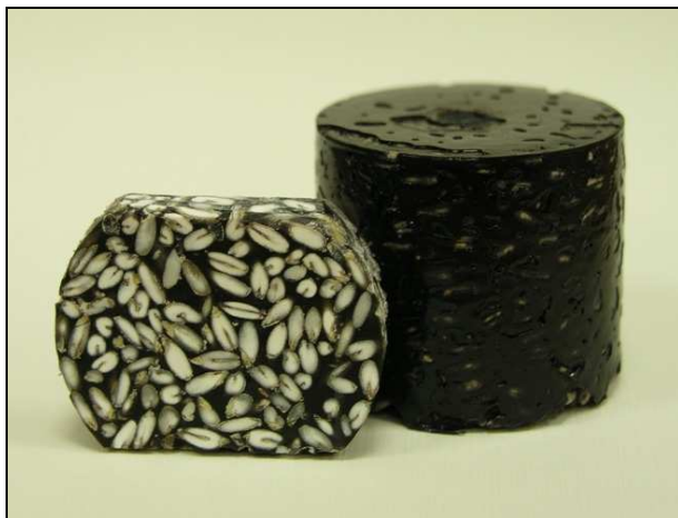
Rys. 1. Przykładowa próbka fragmentu złoża – żyto Dańkowskie Złote Fig. 1. An example of bed sample – Dańkowskie Złote rye
