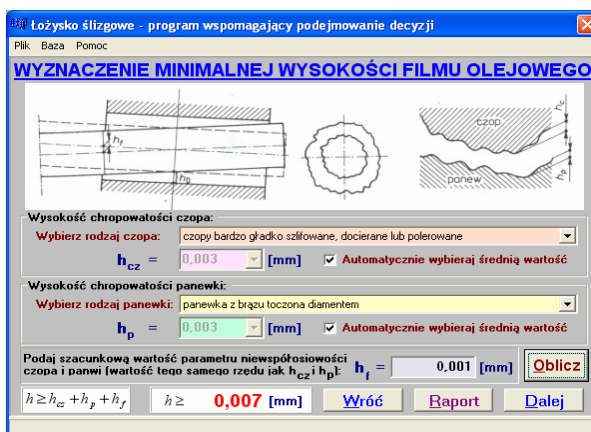
Rys. 4. Okno minimalnej wysokości filmu olejowego Fig. 4. Window of minimum oil film height
