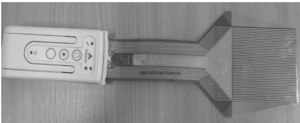
Rysunek 1. System pomiarowy Tekscan Figure 1. Tekscan measuring system
