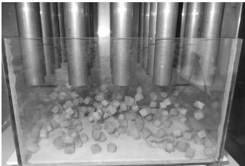
Rysunek 4. Widok fluidującego złoża marchwi w kostce Figure 4. View of the bed of carrots cubes under fluidization
