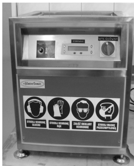
Rysunek 1. Płuczka ultradźwiękowa firmy InterSonic typu IS-40S Figure 1. Ultrasound washer by InterSonic IS-40S
