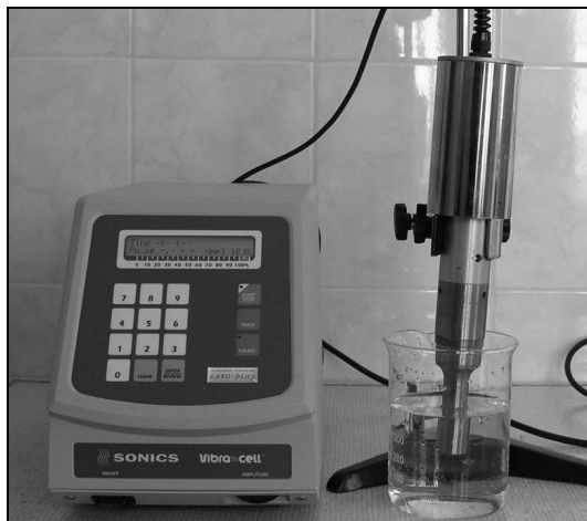
Rysunek 1. Generator ultradźwięków Sonic VC 750
