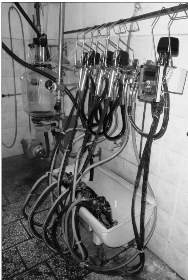
Rysunek 1. Urządzenie udojowe stosowane w badaniach oborowych: 1 – aparat udojowy z wbudowanymi termistorami 2 – mikroprocesorowy rejestrator sygnałów pomiarowych Figure 1. Milking devices used in cowshed tests: 1 – milking apparatus with embodied thermistors 2 – microprocessor recorder of measurement signals
