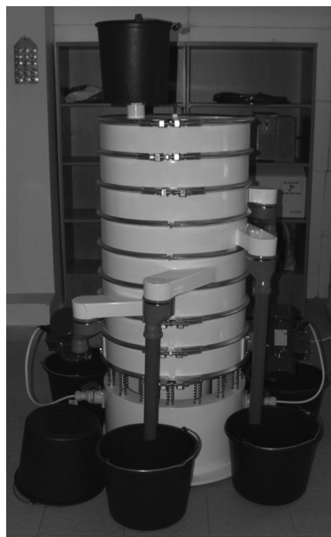
Rysunek 3. Wibracyjny kalibrator do nasion z obiegiem nasion po sicie Figure 3. A vibrating calibrator for seeds with circulation of seeds on a sieve
