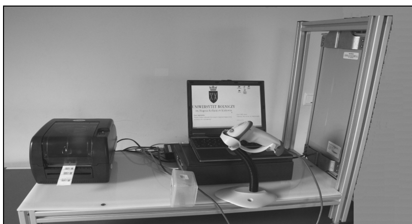
Rysunek 2. Stanowisko badawcze podczas identyfikacji EAN Figure 2. Test rigs during EAN auto-identification
