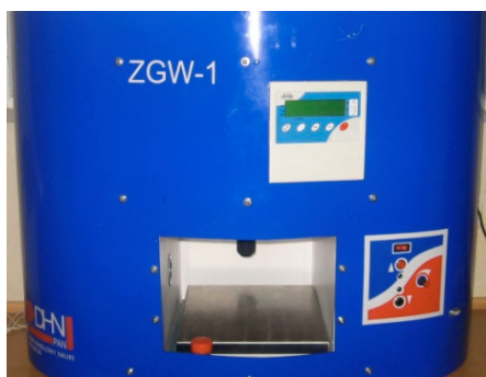
Rysunek 1. Twardościomierz ZGW-1 Figure 1. ZGW-1 Hardness tester
