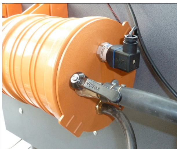
Rysunek 2. Układ stabilizacji podciśnienia Figure 2. The under pressure stabilization system
