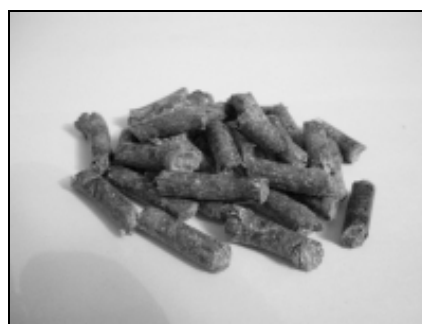
Rysunek 4. Wytworzony pelet z zastosowaniem optymalnych parametrów zagęszczania: a) ze słomy pszennej, b) ze słomy jęczmiennej
