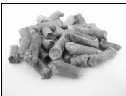
Rysunek 4. Wytworzony pelet z zastosowaniem optymalnych parametrów zagęszczania: a) ze słomy pszennej, b) ze słomy jęczmiennej
