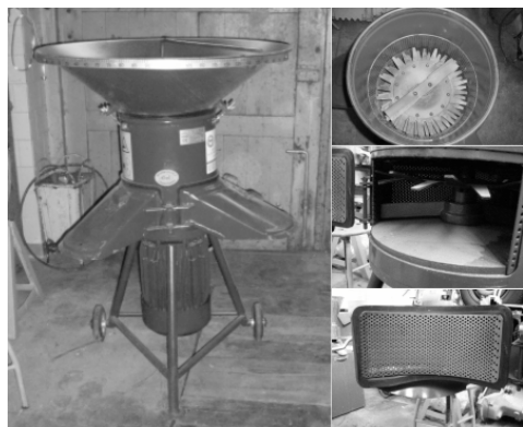
Rysunek 1. Rozdrabniacz bijakowy typu Bąk użyty w badaniach Figure 1. Bąk type beater grinder used in the research
