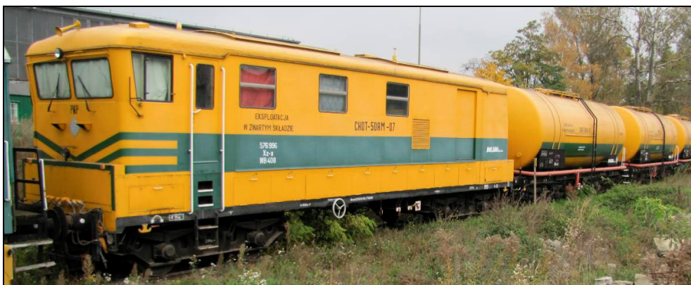
Rysunek 4. Zestaw do chemicznego odchwaszczania torów CHOT-07 (wagon-maszynownia i trzy cysterny).
