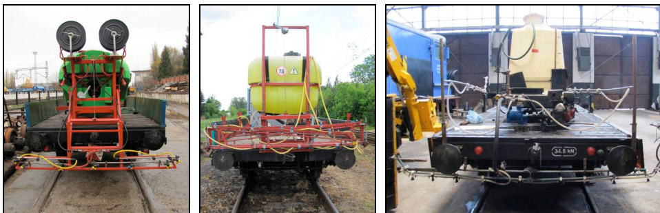
Rysunek 1, 2, 3. Kolejowe opryskiwacze platformowe, od lewej: fabryczny opryskiwacz kolejowy „Krukowiak”, fabryczny opryskiwacz rolniczy „Kwas” adaptowany do potrzeb kolejowych i opryskiwacz kolejowy skonstruowany samodzielnie.
