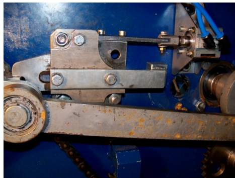
Rysunek 5. Mechatroniczny (pneumatyczny) układ uruchamiający mechanizm włączający aparaty wiążące
