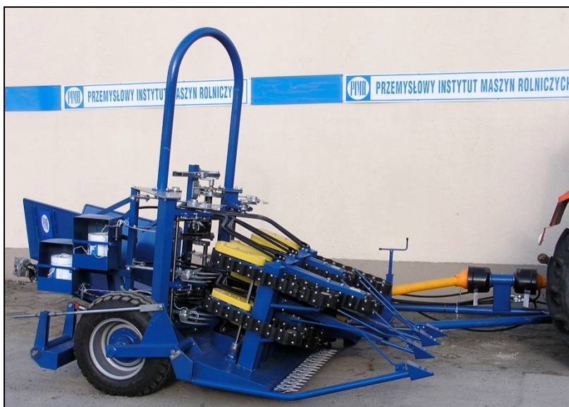
Rysunek 1. Maszyna do zbioru wikliny plecionkarskiej Figure 1. The wicker harvesting machine
