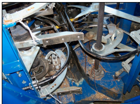
Rysunek 4. Ramiona prowadzące pędy wikliny wraz z czujnikiem regulacji wielkości snopa
