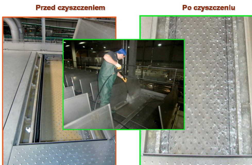
Rysunek 3. Efekt mycia płyt wymiennika ciepła przed wprowadzeniem nowego standardu Figure 3. The effect of washing heat exchanger panels before introducing a new standard
