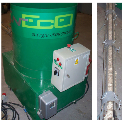
Rysunek 1. Brykieciarka ślimakowa z prowadnicą do stabilizacji brykietów Figure 1. Screw briquetting machine with a guide for stabilizing briquettes
