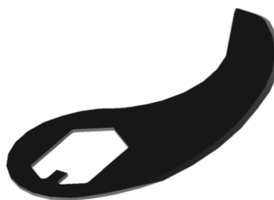
Rysunek 2. Model przestrzenny oryginalnego noża do kutra laboratoryjnego
