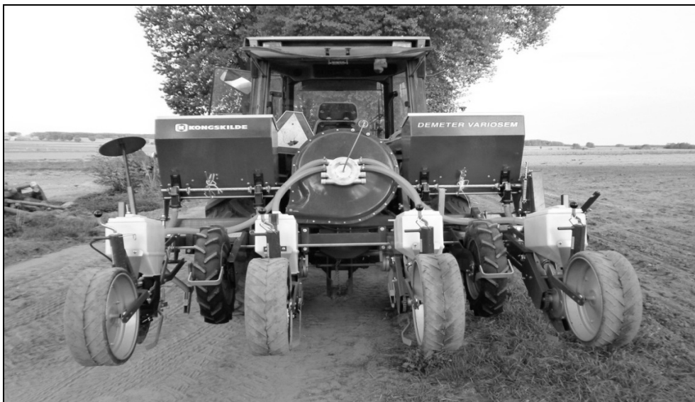
Rys. 1. Widok siewnika precyzyjnego podciśnieniowego Demeter Variosem VM4 firmy Kongskilde
