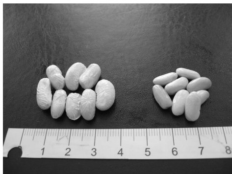
Rys. 4. Porównanie nasion fasoli poddanych godzinnej obróbce termicznej w 52°C w wodzie destylowanej (po lewej) i oleju jadalnym (po prawej) Fig. 4. Comparison of bean seeds subjected to one hour thermal processing in temperature of 52°C in distilled water (on the left) and edible oil (on the right)
