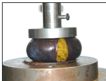
Rys. 1. Wyznaczanie wytrzymałości doraźnej owocu odmiany Presenta
