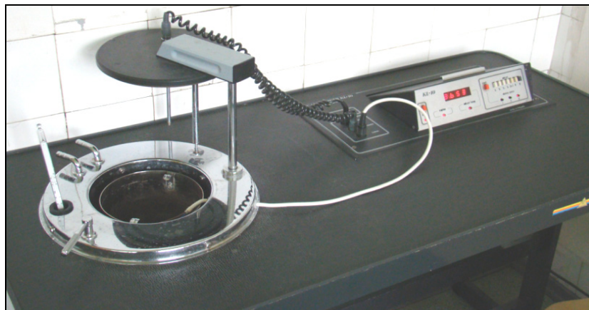
Rys. 2. Stanowisko do badań kalorymetrycznych Fig. 2. A calorimeter research stand
