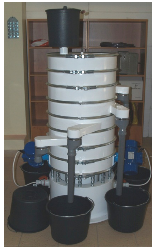
Rys. 1. Schemat modelu przesiewacza rotacyjnego (1 – podstawa przesiewacza, 2 – podstawa kolumny sitowej, 3 – motowibratory boczne, 4 – rzeszota kolumny sitowej, 5 – pokrywa, 6 – zawieszenie sprężynowe)
