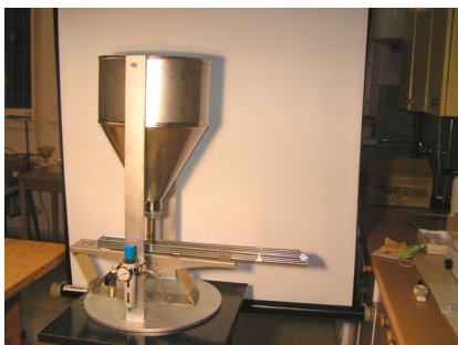
Rys. 2. Dozownik wibracyjny z wibratorem pneumatycznym Fig. 2. Vibrating dispenser with a pneumatic vibrator
