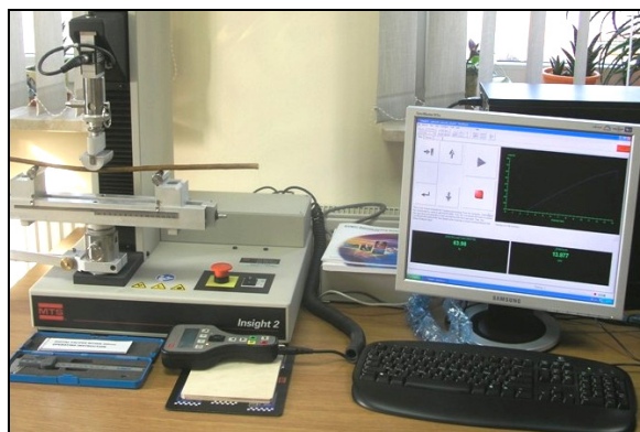
Rys. 2. Maszyna wytrzymałościowa MTS wraz z przystawką do zginania 3-punktowego oraz jednostką sterująco-archiwizującą
