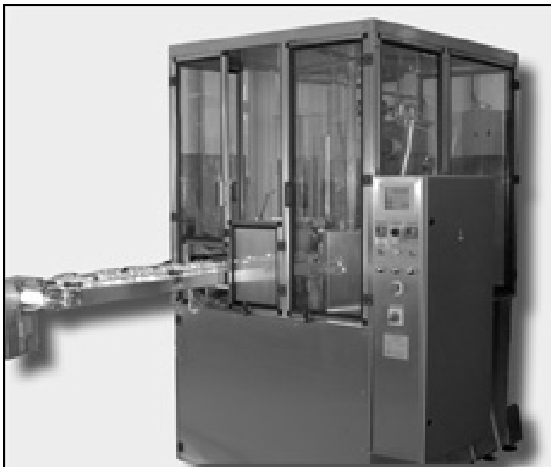
Rys. 1. Automat do pakowania artykułów półpłynnych PAG-40 Fig. 1. PAG-40 – automatic machine for semi-fluid product packing
