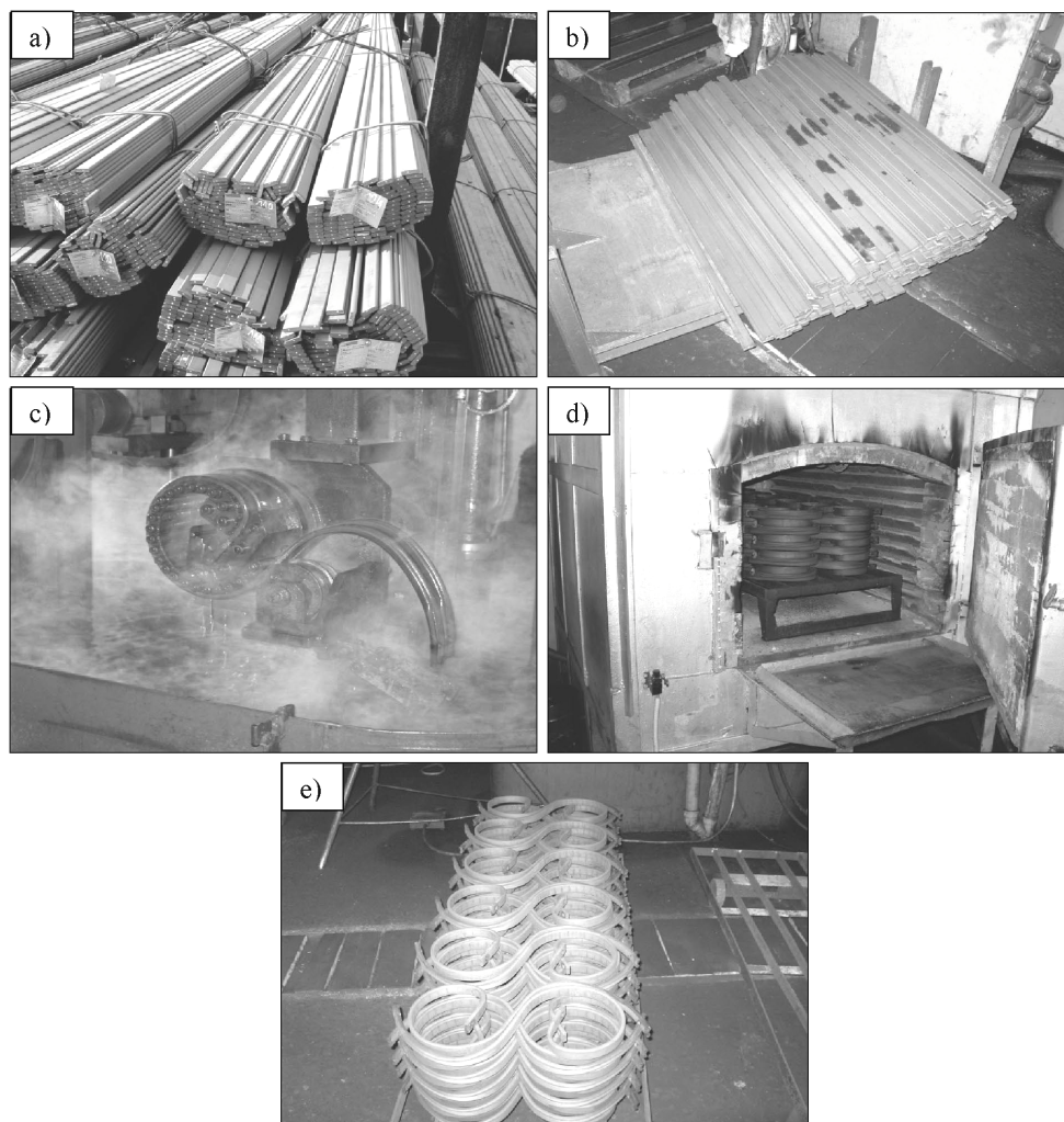
Rys. 2. Zestawienie faz produkcji lekkich sprężynowych zębów kultywatora: a) materiał, b) ciecie na wymiar oraz dziurkowanie otworów, c) gięcie, nagrzewanie i hartowanie, d) odpuszczanie, e) malowanie [Opracowanie własne]
