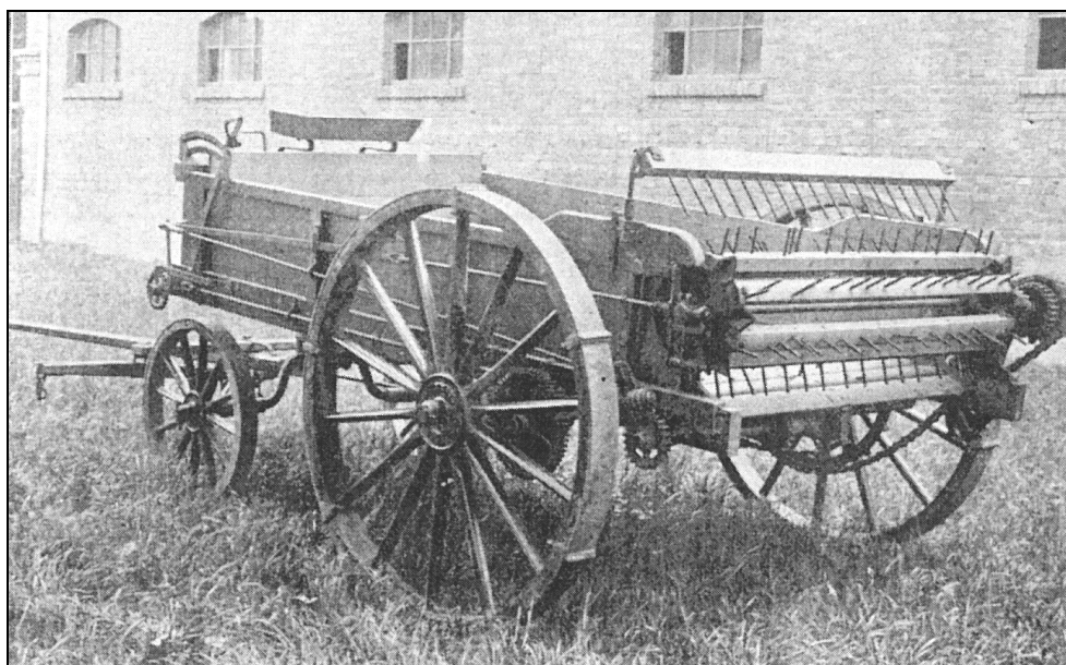
Rys. 5. Amerykański roztrząsacz obornika i rozsiewacz wapna „Success” (wg Nachtweha 1907) Fig. 5. American dung spreader and lime distributor „Success” (acc. to Nachtweh, 1907)
