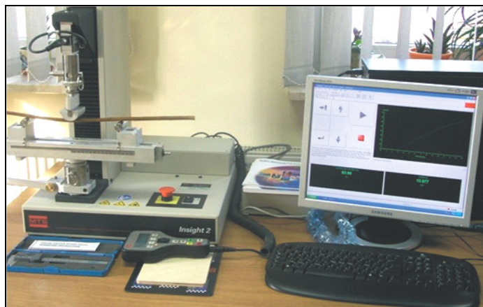
Rys. 1. Maszyna wytrzymałościowa MTS wraz z przystawką do zginania 3- punktowego oraz jednostka sterująco-archiwizująca
