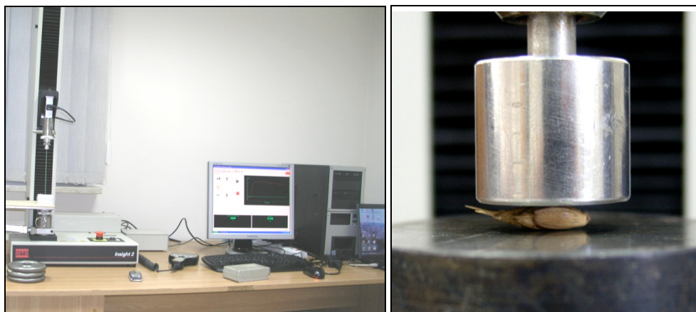
Rys. 1. Maszyna wytrzymałościowa Insight 2 firmy MTS oraz szczęki do ściskania materiałów Fig. 1. Testing machine Insight 2 by MTS and jaws for compression of materials
